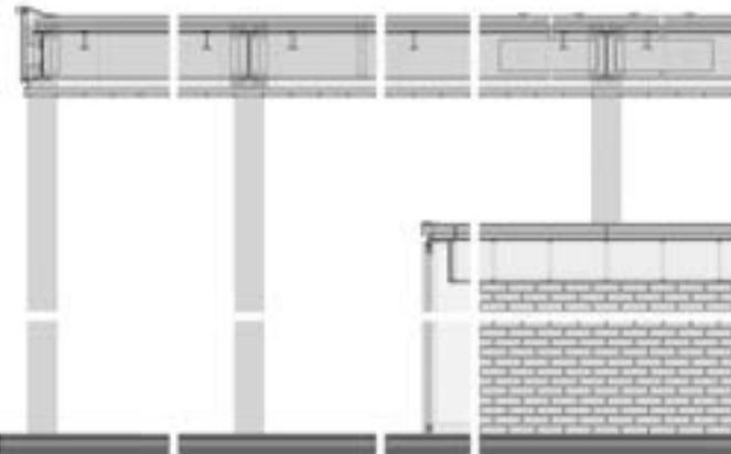
La cubierta se cierra superiormente por un chapa metálica grecada tipo deck, aislamiento térmico de placas de poliestireno extruido de célula rígida, una capa separadora de fieltro sintético de fibra de poliéster y una membrana impermeabilizante fijada mecánicamente.
