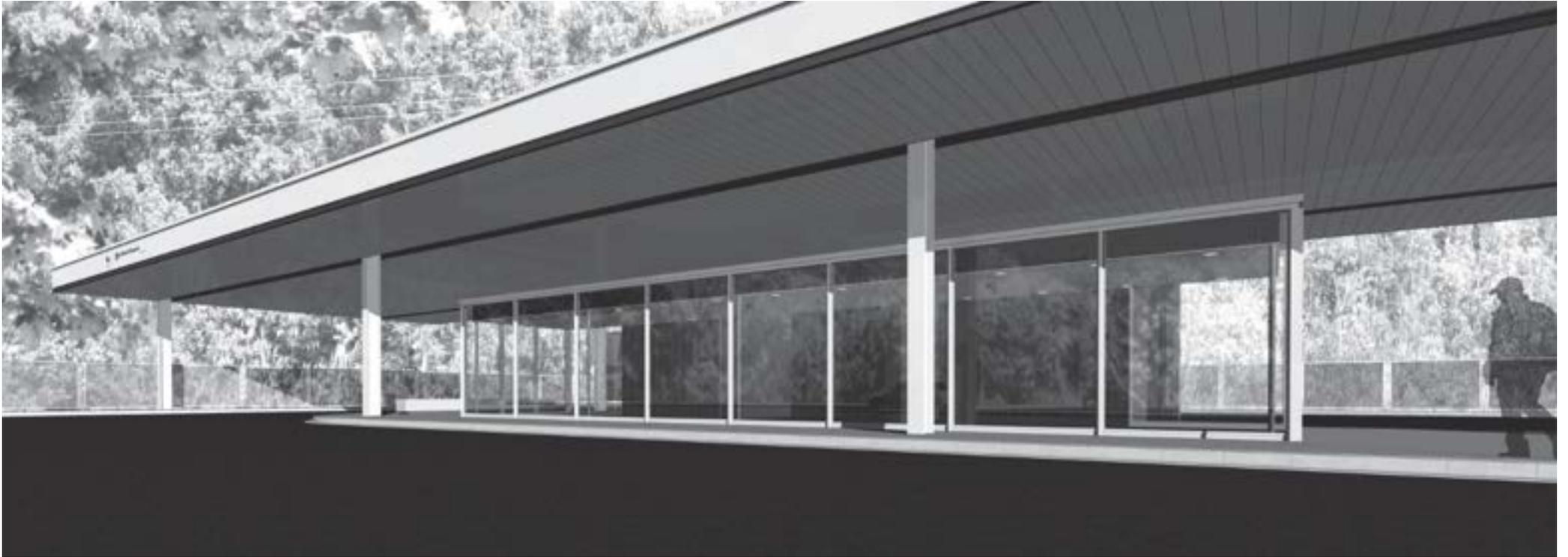
En el pabellón, el espacio de espera, se cierra en su perímetro con vidrio de seguridad, doble hermético, sobre un bastidor de acero visto al exterior. Ésta estructura le otorga la rigidez necesaria a la fachada frente a los fuertes vientos de la zona.
