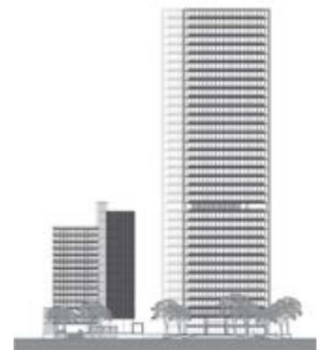
En los pisos de oficinas se ha dejado una pasarela de mantenimiento. En las orientaciones más comprometidas se ha instalado una celosía de aluminio como protección solar. En la placa se proyectó una fachada ventilada de cristal con regulación de la ventilación automática y una protección interior en base a una veneciana retráctil.
