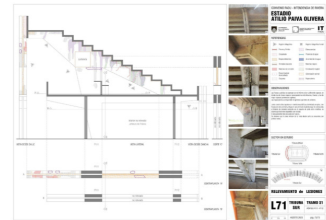
Figura 3. Mapeo de lesiones del tramo 01 de tribuna Sur. Pórtico P111-P112.
