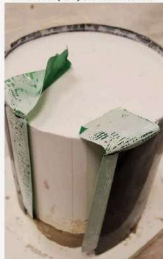
Relleno con yeso y desmolde tras secar
