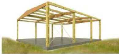
FASE 2 Montaje de la estructura Pilas + carchas + cornisa Rigilización de la estructura laestérica
